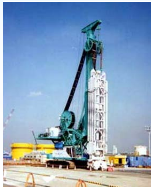
回転式掘削機
