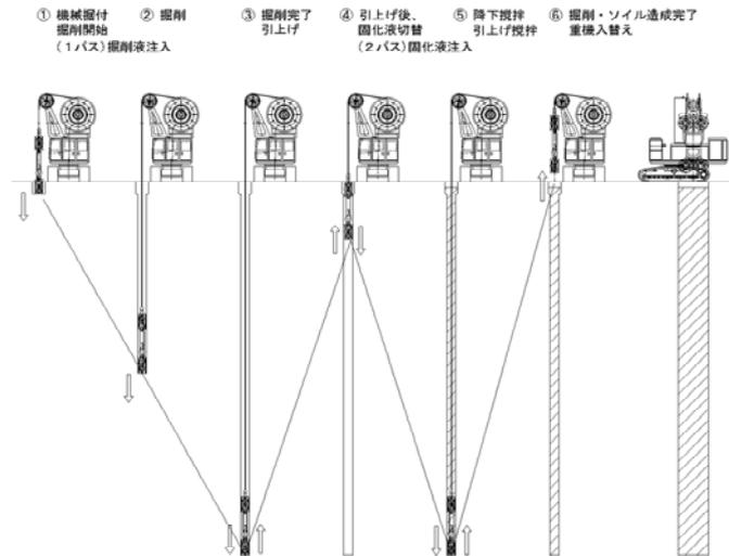
図4.2.1 2サイクル施工概要図
