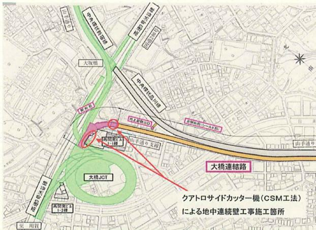
図-4 中央環状品川線大橋連絡路 概要図
