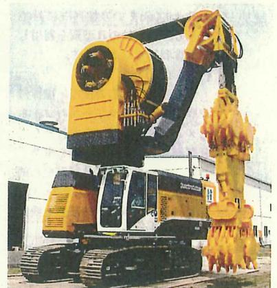
写真-3 CSM工法施工機械 (クアトロサイドカッター)
