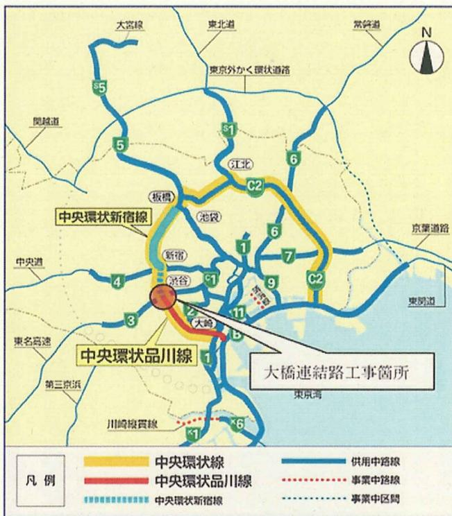
図-1 中央環状品川線大橋連結路工事箇所
